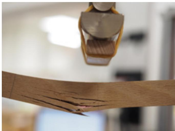
Ein Buchenholzstab wird maschinell so lange belastet, bis dieser bricht, um seine Elastizität und Festigkeit zu bestimmen.
